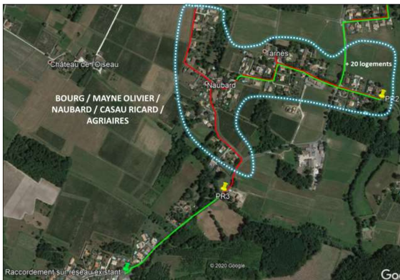
Figure 7 : Vue satellite avec réseaux et ouvrages projetés - Secteurs Bourg / Mayne Olivier / Naubard / Casau Ricard / Agriaires
