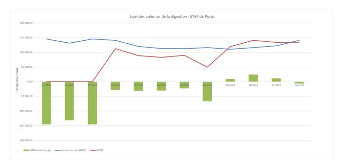
Ce tableau représente la consommation énergétique pour le fonctionnement de la station d'épuration de Porto par rapport à l'énergie créée (Biogaz) grâce à la méthanisation. Tout comme le tableau précèdent, la période de Janvier à Mars correspond aux essais sur mise en route.
